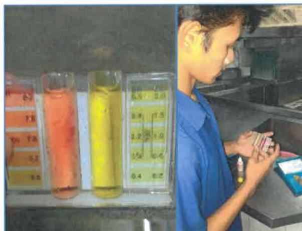
ภาพถ่ายที่ 3.4.3-1 การตรวจเช็คค่าความเป็นกรดต่างและคลอรีนอิสระคงเหลือของสระว่ายน้ำประจำวัน
